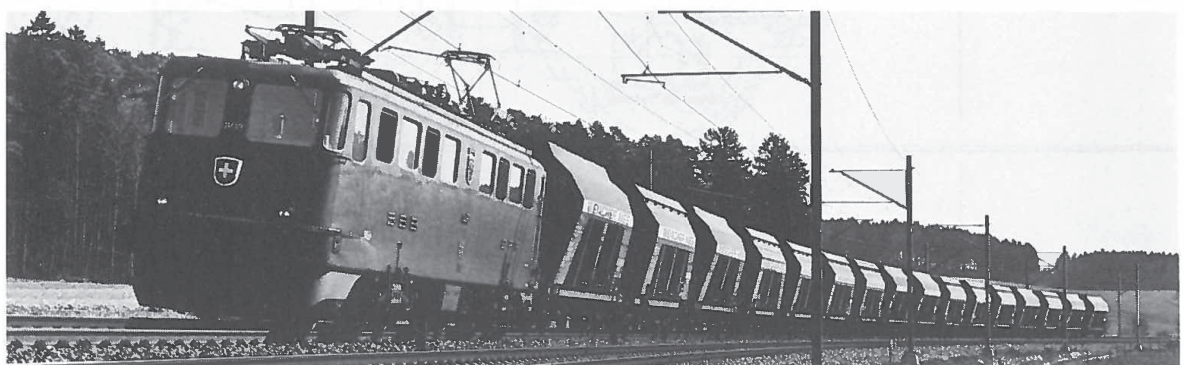
Kies-Blockzug aus «Weiacher Kies»-Wagen mit Ae 6/6 11449 bei Bassersdorf. Man beachte die verschiedenen Ausführungen des Aufsatzes (geschweisst oder aufgeschraubt), der das internationale Lademass überschreitet und erst nachträglich angebracht worden war. Foto: P. Hofmann, Vevey
