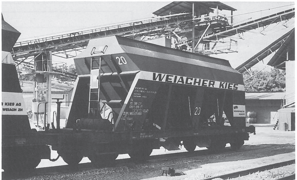
Das Vorbild des REA-Baukurses, der Schüttgut-Selbstentladewagen «Weiacher Kies», auf dem Anschlussgleis in Zweidlen (Strecke Eglisau–Koblentz) im heutigen Zustand. Foto: P. Hofmann, Vevey
